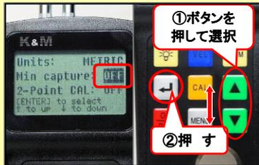
①「▲▼」キーで[System setup]を選択し、②「↓」キーで確定する。
