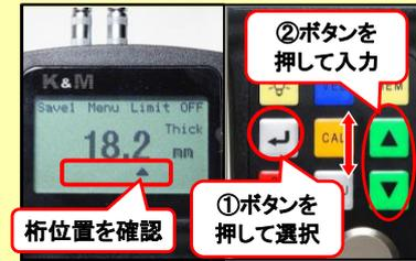
プローブを離し①「↓」キーで桁を選択し②「▲▼」キーで2点目の試験片の厚さを入力する。
