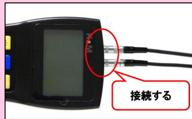
KT-300(上部コネクタ)とプローブ(探触子)をケーブルで接続する。
