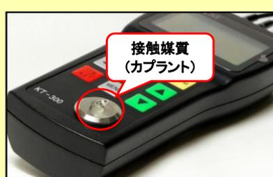
接触媒質(カプラント)を本体下部の零点調整用試験片に少量塗布する。
