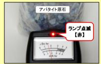
左側のスイッチを『ON』に合わせる。 右側の「レンジ切替」スイッチを 『×1』に設定する。 検出器窓を測定物に向ける。
