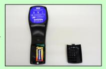
本体裏の電池カバーを外す。 9Vのアルカリ電池を本体のコー ドに接続し入れる。
