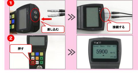
KT-310D(上部コネクタ)と探触 子(トランスデューサー)をケーブ ルで接続する。
