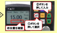
トランスデューサーを離し①「』」 キーで桁を選択し②「▲▼」キー で厚い方の試験片の厚さを入力 する。
