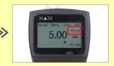
「CAL」キーを押す。 1点目の校正を終了します。 【Thick】と表示される。
