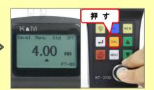
接触媒質(カプラント)を塗布した零点調整用試験片にトランスデューサーを接触させる。「CAL」キーを押す。※零点調整は【Std】モードで行って下さい。この状態が零点(基準)になります。※音速を5900m/秒に設定の場合、4.00mmと表示されます。
