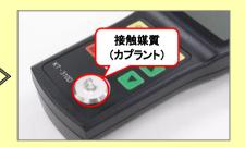
接触媒質(カプラント)を本体下部の零点調整用試験片に少量塗布する。
