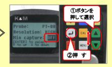
①「▲▼」キーで【System setup】を 選択し、②「』」キーで確定する。
